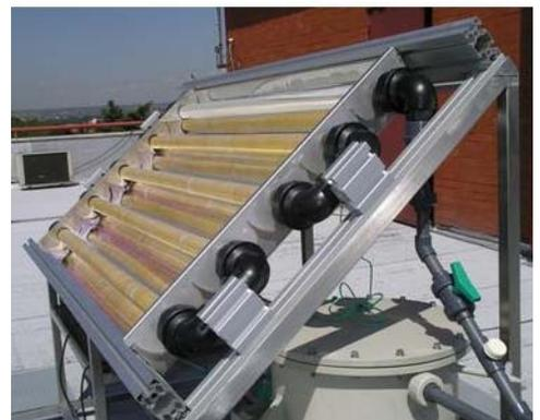
La eficacia de los fotorreactores solares se ha ensayado en la UCM, consiguiendo la desinfección de aguas artificialmente contaminadas con hasta 10<sup>4</sup> UFC/mL de las bacterias *Escherichia coli* (Gram-) o *Enterococcus faecalis* (Gram+) en un típico día soleado, en 4–5 h de iluminación.
